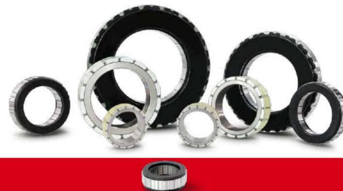
无框力矩电机不同于传统伺服电机, 只有定子和转子2个部件。相较于有框电机, 无框电机配置灵活、安装方便。着眼于目前驱动系统的高度集成化趋势, 无框电机更贴合工程师的目标期望, 工程师无需像传统设计那样考虑电机接口, 在系统设计中可以最大限度的缩小驱动系统中动力输出单元的空间占用, 以此来达到更高的系统集成。
